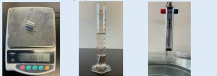
【図1】おもりを量る様子 【図2】おもりをメスシリンダーに入れた様子 【図3】水中にあるときの重さ(N)を量る様子
